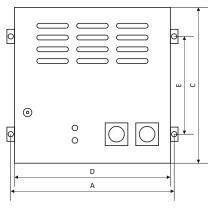
Strom SEC: Spannung PRI: Art der Steuerung: 1,5 - 14A 3 x 400V 50/60Hz 5-stufige Regulierung
