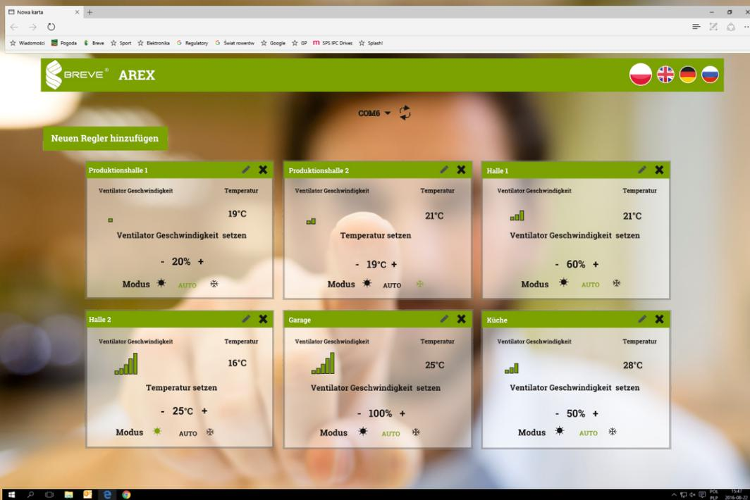
Das RegiSoft System basiert auf den Ventilator Drehzahlreglern der Reihe AREX/A, ausgestattet mit MODBUS Protokoll und Softwareanpassung für PC Computer.
